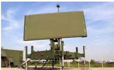
Los radares AN/TPS-78 Advanced Capability (ADCAP) y ADCAP Multi-Mode incluyen un subsistema de seguimiento marítimo y UAS pequeños con detección y seguimiento automáticos integrados. Su propósito es detectar y rastrear todos los objetivos en movimiento aéreo y marítimo lento dentro del volumen de cobertura del sistema proporcionando algoritmos avanzados de iniciación y continuidad de seguimiento y tasas de seguimiento falsas reducidas.
